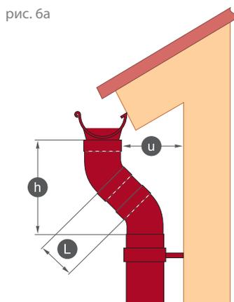
Выберите длину промежуточной части трубы в соответствии с приведенной таблицей и рисунком (рис. 6а). Метровая труба Grand Line® обжата с двух сторон, что позволяет разрезать ее и использовать для двух стояков. Если соединительная труба используется для одного стояка, то максимальная длина трубы составляет 90 см. Обжим сверху (10 см) необходимо срезать, иначе стыковка с последующими элементами будет невозможна.
