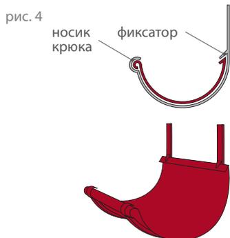
Вставьте желоб в крюк, заведя внутренний край желоба в фиксатор, затем зафиксируйте внешний край желоба накладным пластинчатым фиксатором (рис. 4). Внешний край желоба должен быть ниже внутреннего на 6 мм в целях предотвращения попадания воды на фасад во время сильных ливней.
