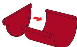
Заглушки устанавливаются на торцы желоба, не стыкующиеся с другими элементами (рис. 3). Установите на торец желоба заглушку, загерметизируйте стык силиконовым герметиком, в случае необходимости применяйте заклепки. Для более плотного соединения воспользуйтесь резиновой киянкой. Одно ушко заглушки прикрывает завиток желоба, другое – вплотную загибается на заднюю часть желоба. Для дополнительной фиксации ушко можно закрепить с помощью самореза.
