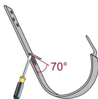
Крюки под желоб следует закрепить так, чтобы расстояние между продлением линии уклона крыши и верхним наружным краем желоба было не менее 25 мм. Перед установкой длинных крюков необходимо отогнуть пластинчатый фиксатор у каждого крюка отверткой. Угол отгиба пластинчатого фиксатора должен составлять  $70^\circ$  (рис. 1с).
