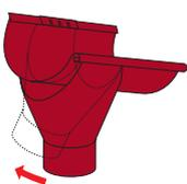
Разметьте предполагаемые места установки воронок и вырежьте в желобе с помощью ножовки либо ножниц по металлу V-образное отверстие шириной 100-110 мм.
