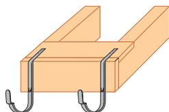
Установка длинных крюков производится на стропила или на карнизную доску до укладки кровельного материала (рис. 1а, 1б). В случае если крюки устанавливаются после полного устройства кровли, необходимо воспользоваться компактными или короткими крюками для крепления на лобовую доску.
